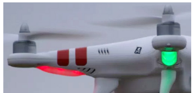
Rote und grüne LED-Beleuchtung am Beispiel der Drohne »Phantom«
